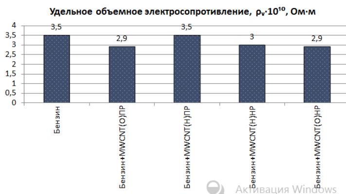
Рис. 12. Удельное объемное электрическое сопротивление жидкостей на основе керосина ТС-1
