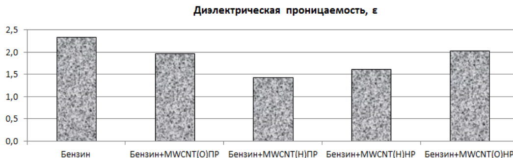
Рис. 9. Диэлектрическая проницаемость жидкостей на основе бензина НЕФРАС-С2-80/120
